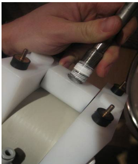
Kuva 2, Tapflo pumppu Kiinnitä imuputki ja 4 kpl M4 kumityynyjä pumppuun
