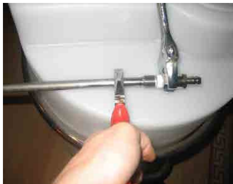
Kuva 1a) Irrota muhvi ja letkunippa Imuputkesta.
